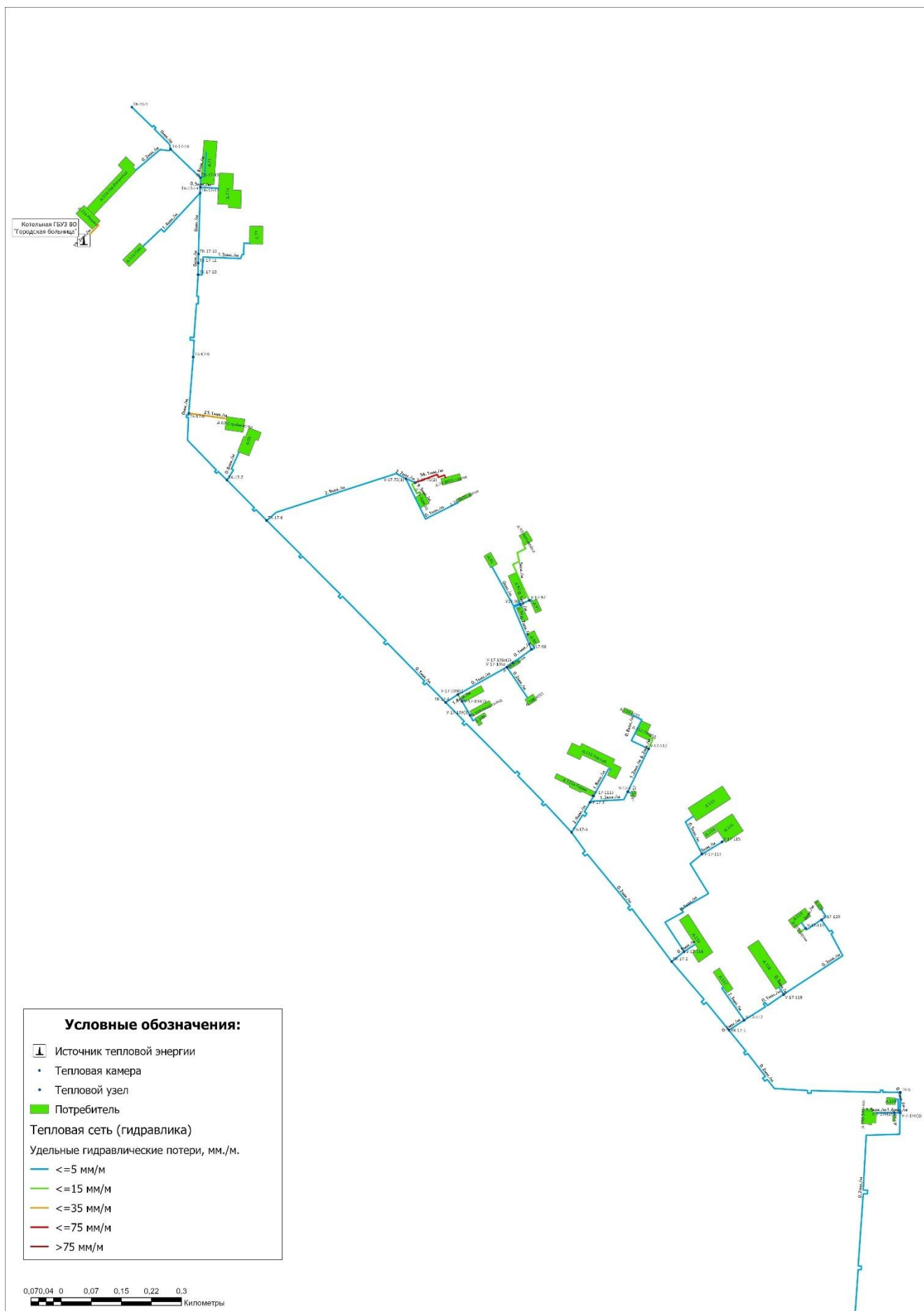
Рисунок 3.4.3 - Удельные гидравлические потери давления в трубопроводах тепловых сетей на территории ЗАТО город Радужный (квартал 17)
