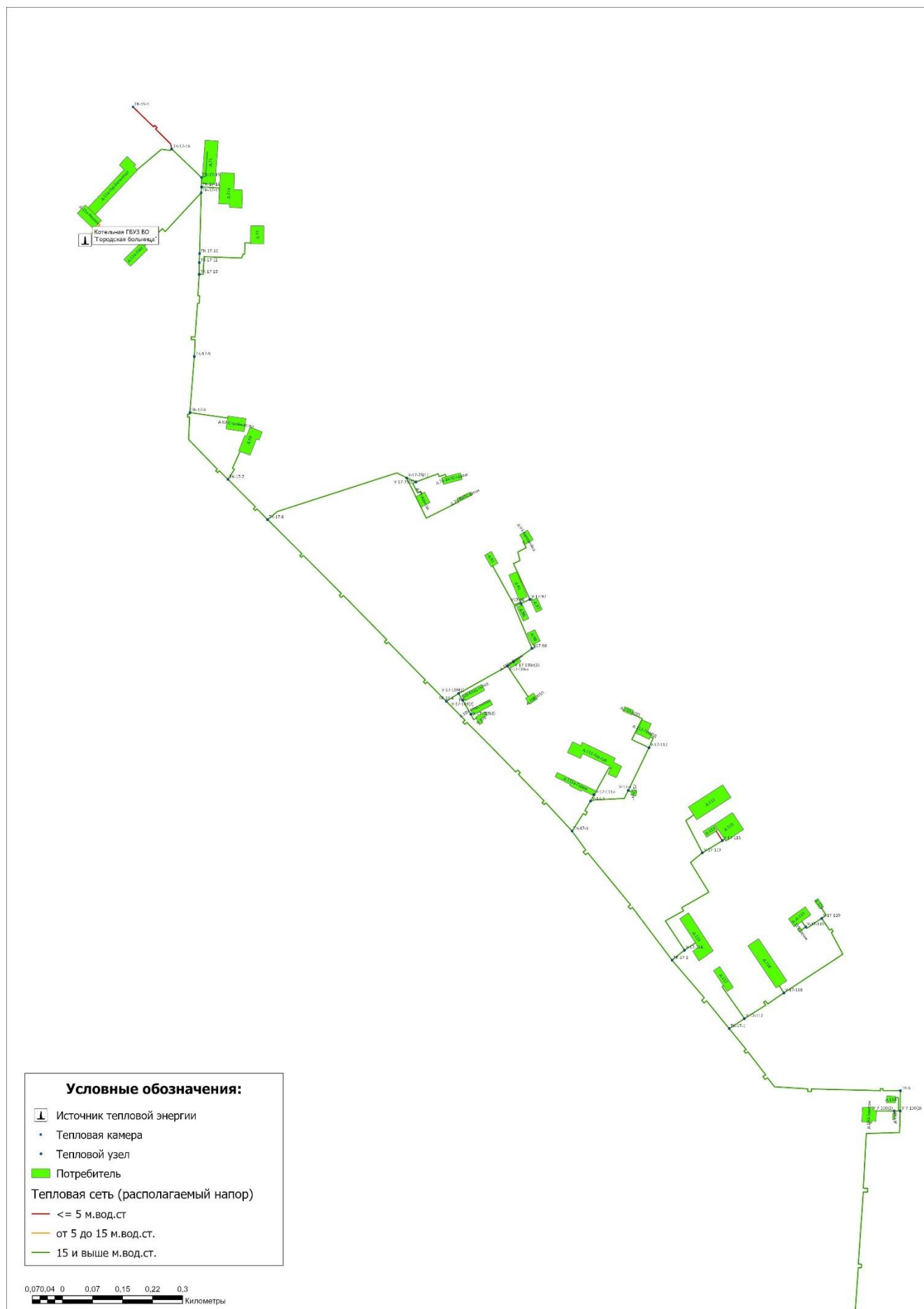
Рисунок 1.6.2.3 - Располагаемый напор на участках тепловых сетей ЗАТО город Радужный (квартал 17)
